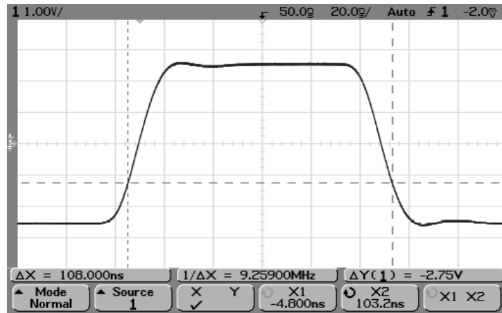
游标测量非 50% 点处的脉冲宽度
